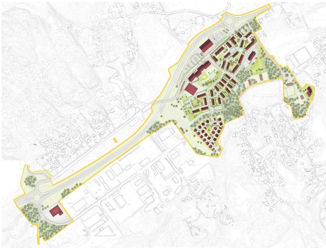
Figur 4, Illustrationsplan som visar hur området kan komma att utformas. Detaljplanen reglerar inte exakt placering av byggnader varför andra utformningsalternativ också är möjliga. Planområdet redovisas med gul linje.
